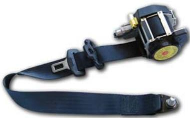
Un incidente con un muletto può avere conseguenze gravissime, fino alla perdita della vita... una curva a velocità elevata o un carico superiore alla portata, può causare il ribaltamento del mezzo. Senza i dispositivi di trattenuta (cinture di sicurezza, ad esempio), potreste rimanere schiacciati fra il tetto di protezione e la superficie. Pertanto, per l'utilizzo in sicurezza di un carrello elevatore è sempre indispensabile ... tanta prudenza!
