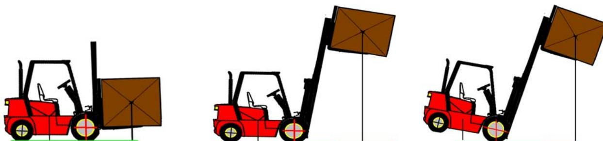
Quindi, brandeggiate in avanti, soltanto se siete in una posizione o manovra molto sicura: ad esempio per aggiustare la posizione delle forche in uno scaffale. Ancora ... massima attenzione alle forche del vostro mezzo quando sono alzate: una sconnesione della pavimentazione o una pendenza della stessa ... potrebbe dar luogo al ribaltamento del nostro carrello elevatore!
