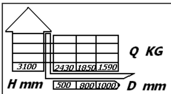
Nell'esempio, il sollevamento massimo sarà di 3100 mm (3,1 metri) a filo delle forche, con montante in posizione verticale.
