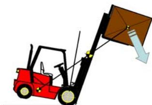
I muletti possono essere paragonati ad una bilancia: il peso del carico movimentato davanti e il peso del carrello elevatore dietro.
