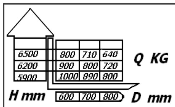
Ma se ... il carico massimo dei 1000 kg ... dobbiamo alzarlo fino a 6.5 metri ... possiamo?
