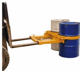
Elementare: se prima potevo sollevare 1000 con le sole forche ... ora ... avendo aggiunto le pinze ... diminuisce la portata massima! Infatti, il "pezzo speciale" aggiunto aumenta il peso spostando il baricentro del carico e riducendo, di conseguenza, la portata del carrello elevatore.
